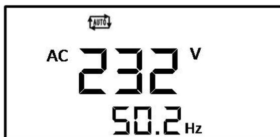
Ejemplo: Tensión y frecuencia (Hz) de corriente alterna del grupo electrógeno
