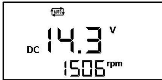
Ejemplo: Tensión DC de la batería y velocidad de marcha del grupo electrógeno (RPM)
